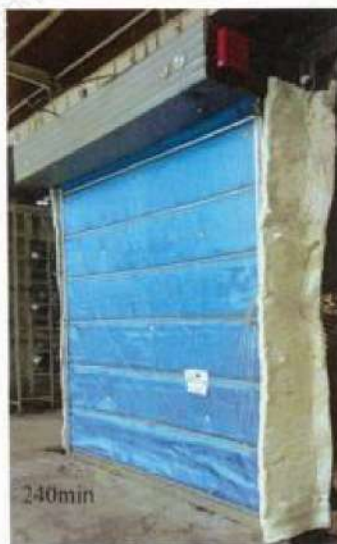
照片 2 耐火试验结束时试件情况
