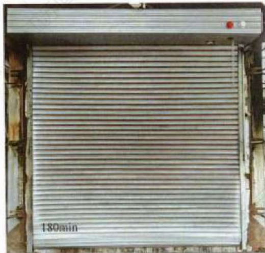
照片 2 耐火试验结束时试件情况
